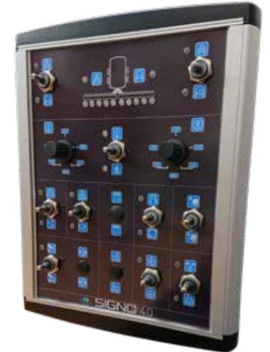
Dieses intuitive Bedienterminal ist für Traktoren ohne ISOBUS konzipiert worden. Das stabile, abnehmbare Alu-Gehäuse beinhaltet neben den Kippschaltern eine Folgeschaltung der Ausbringergeräte und Statusanzeigen wie u.a. „Tank leer“. Bei Ausbringgestängen mit Teilbreitenschaltung wird bei Pumpfässern die Ausbringmenge automatisch um 50% reduziert.
