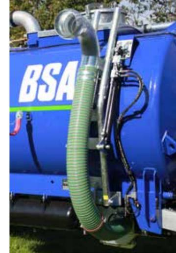
Seitlicher Saugarm, Standardausführung mit Spiralschlauch
