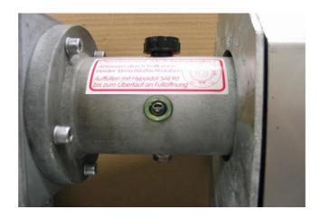
Bei erfogter Montage ist der Ölstand im Antriebskopf zu kontrollieren.
